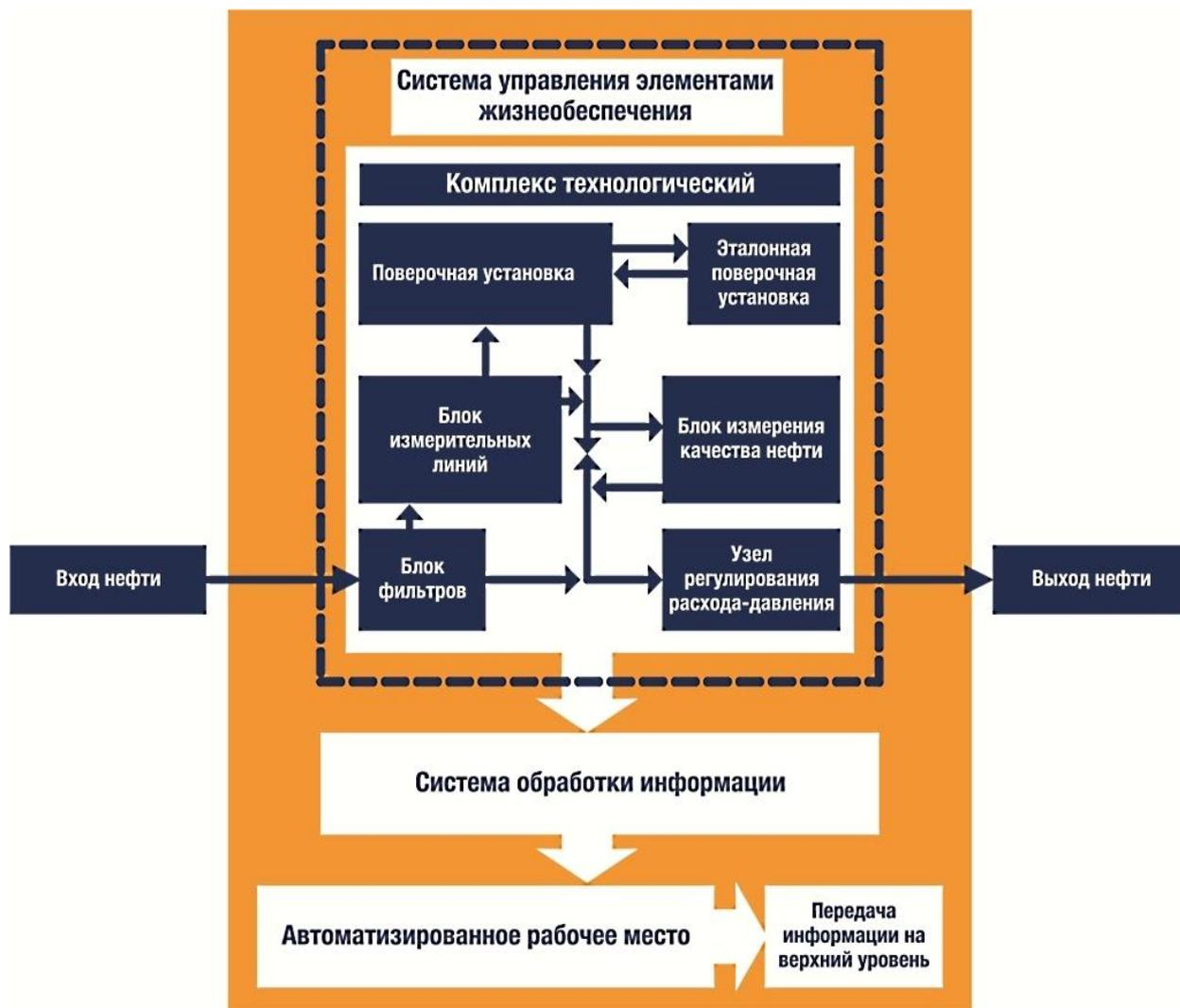
В зависимости от назначения системы измерения могут иметь индивидуальные особенности и различаться по составу оборудования, в зависимости от требований Заказчика.
